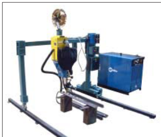
上图：龙门式焊接系统，配置 Miller 公司埋弧焊电源，带焊料回收装置
