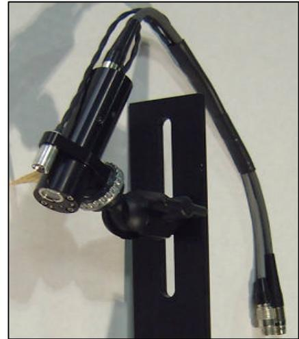
本系統有兩種可選型號：VMS-1600 攝像頭與電弧的安裝距離是 6"(152mm)，通常使用空冷方式（如果需要，也可以改用水冷或氣冷方式）。此攝像頭適合焊炬周圍有較大空間的場合，或者因焊炬周圍有其他設施，如電磁偏擺或送絲元件，或焊縫比較深的情況。
