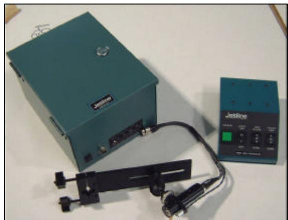
整體式 CCD 成像元件使用電子快門，採用獨特的 ND-點狀濾光鏡。焊接開始之前，控制臺上的光柵開關使點狀濾光鏡增強；焊接結束後，光柵打開，點狀濾光鏡減弱。ND-點狀濾光鏡的作用是過濾電弧光的直射，只允許焊縫周圍的散射光通過對應的濾色鏡，所達到的效果是：無論是高亮度的電弧還是低亮度的熔池和焊縫周邊環境，都可以清楚地顯示出來，而不必來來
