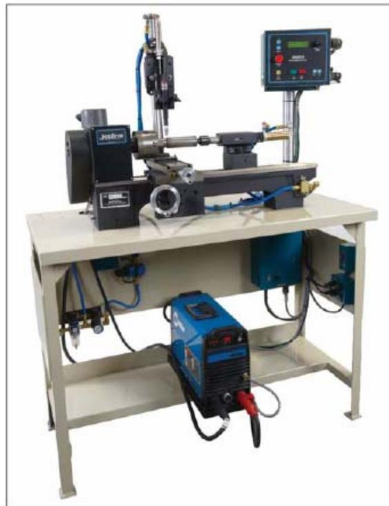
定主轴转速、运行延时时间和停止延时时间等，显示焊接前和焊接过程中的转速。
